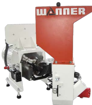
Mlecí komora řezacího mlýnu je lehce přístupná a dobře se čistí.
